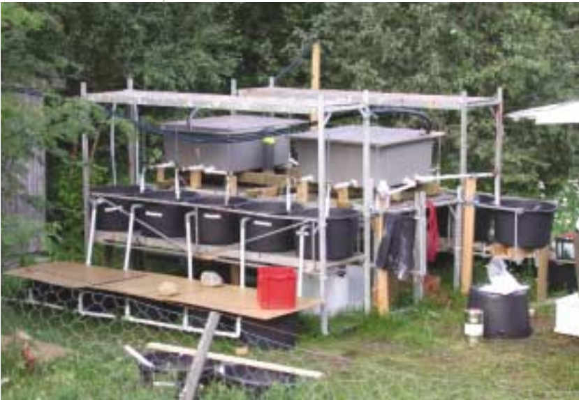
Figur 3. Forsøksoppsettet som ble brukt under feltforsøk i Lærdal. Legg merke til de sorte slangene som fører vann fra Lærdalselva inn i de store tankene på toppen. Derfra fordeles vannet til de ulike eksponeringskarene. Tilsetning av aluminium skjer ved hjelp av peristaltiske pumper som doserer inn sur Al-løsning.
