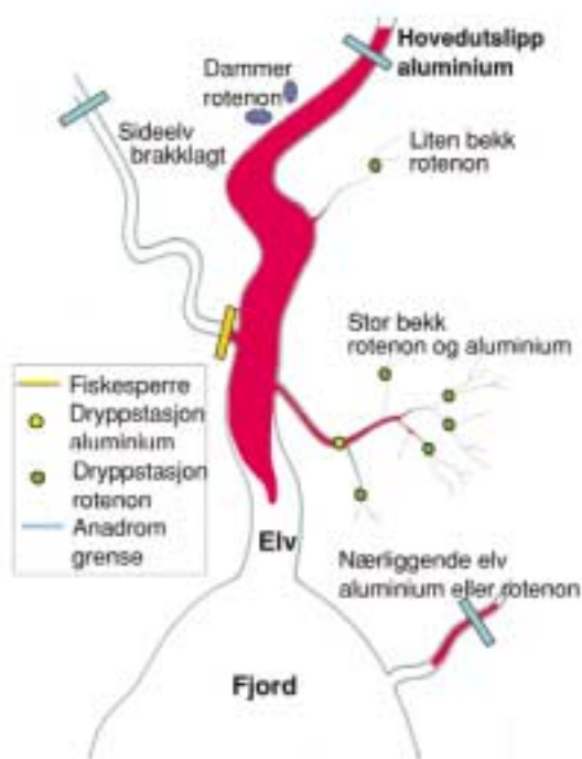
Figur 1. Skisse over en mulig kombinasjon av ulike tiltak i et Gyrodactylus salaris -infisert vassdrag. Aluminium (markert med rødt) brukes i hovedløpet og i større sidebækker. Rotenon benyttes i utvalgte sidebækker, dammer, vanskelige og perifere områder med kun sporadisk kontakt med elva og komplekse områder med spesielle utfordringer. Sperrer brukes for å begrense parasittens utbredelse og for å hindre oppvandring av potensielt infisert laks under behandlingen.
